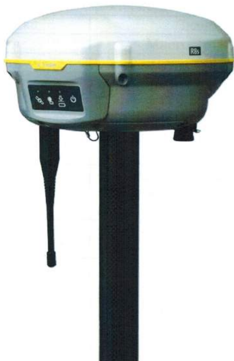
Рисунок 1 - Внешний вид аппаратуры геодезической спутниковой Trimble R8s
